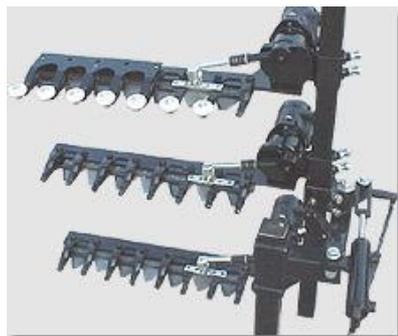
Расстояние между вертикальными режущими рамами у базовой модели регулируется гидравликой в пределах от 130 до 210 см.
