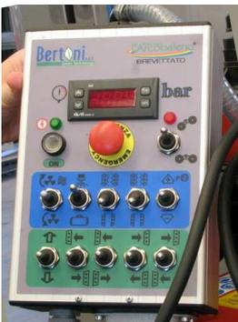
Электронный дистанционный пульт управления устанавливается в кабине трактора и обеспечивает легкое управление всеми функциями опрыскивателя, а также хранение в памяти нескольких рабочих настроек для их автоматического применения при переходе от одного участка к другому (опция).
