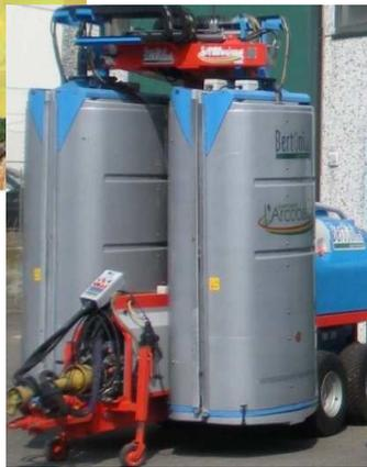
Данный опрыскиватель оснащен патентованной системой внесения СЗР с помощью воздушного потока, генерируемого вентиляторами. Сбор и повторное использование рабочего раствора обеспечивается системой рециркуляции и фильтрации с вертикальными полосами – ламелями. Данная система позволяет экономить не менее 50% препаратов в среднем за сезон. Привод вентиляторов опрыскивателя электрический, от генератора постоянного тока 24 в.
