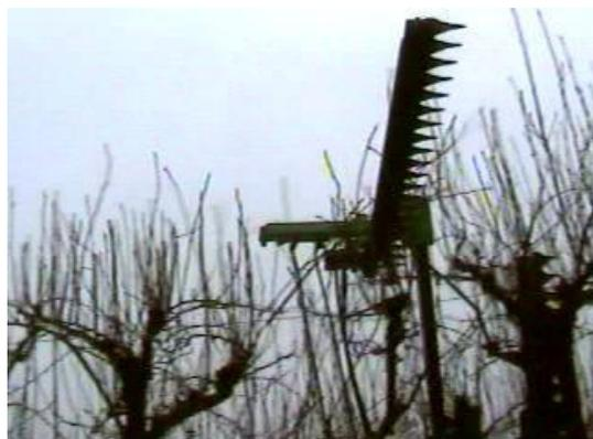
Данная модель обеспечивает обрезку ветвей фруктовых деревьев до 4 см в диаметре. Машина предназначена для крепления спереди трактора. Небольшой вес – до 300 кг и наличие независимой системы гидропривода позволяет использовать ее с тракторами малого класса. Есть положительный опыт использования данной машины в Украине с трактором МТЗ 320.
