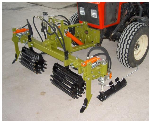
Переднее крепление оборудования дает возможность лучшего визуального контроля и управления работой, особенно у двухсторонней секции.
